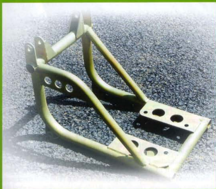
Der Motorhalter für den HKS stammt vom Rotax 912 Viertakter (unten).
