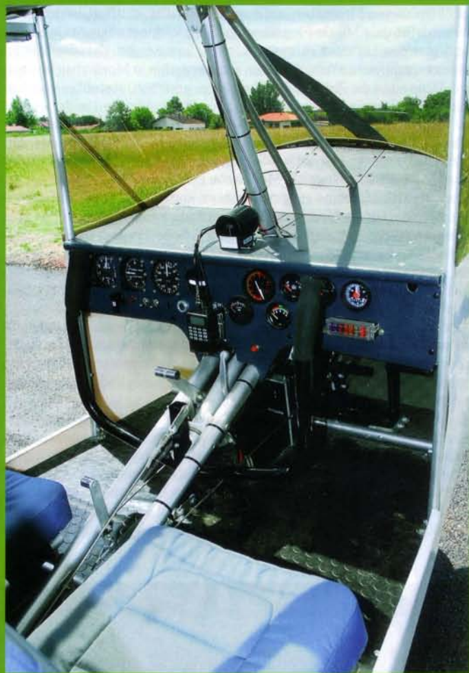
Außergewöhnliche Mittelkonsole: Gas, Bremse und Klappen sind auf einer Konsole untergebracht, die aus zwei Rohren besteht (oben). Rohr-Tuch: Bis auf die Motorverkleidung ist der Sky Ranger noch ein echtes Rohr-Tuch-UL. Der Rumpf ist, wie die Tankflächen, mit UV-beständigem X-Lam bespannt (links).
