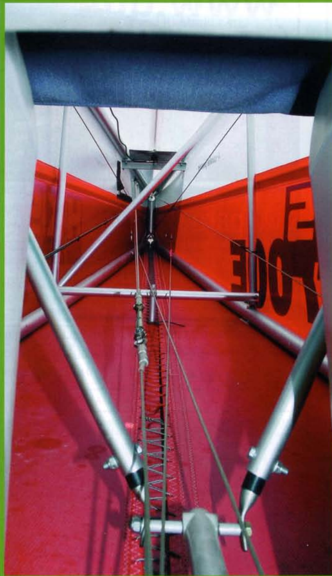
Außergewöhnliche Mittelkonsole: Gas, Bremse und Klappen sind auf einer Konsole untergebracht, die aus zwei Rohren besteht (oben). Rohr-Tuch: Bis auf die Motorverkleidung ist der Sky Ranger noch ein echtes Rohr-Tuch-UL. Der Rumpf ist, wie die Tankflächen, mit UV-beständigem X-Lam bespannt (links).
