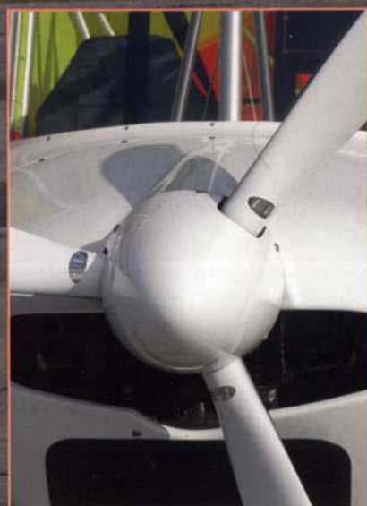
Leise und effektiv: Auch der Propeller stammt aus der Ukraine - vom Hersteller Kiev Prop; die beiden Lufteinlässe sorgen für Kühlung
