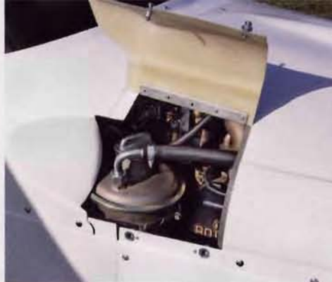
Checkklappe mit Schnellverschlüssen: Hinter den rechten Zylindern ist der Motorölbehälter des Rotax 912 gut zugänglich
