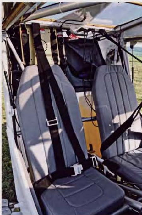
Alles offen: Hinter den verstellbaren Sitzen sind die Tanks montiert, darüber links das Rettungssystem, rechts das Gepäckfach
