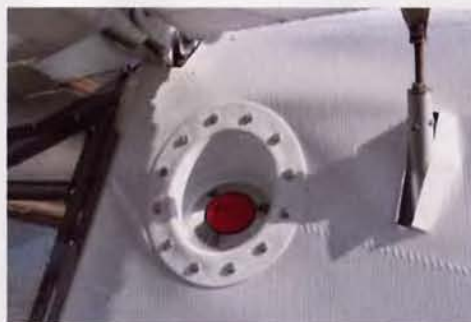
Von außen tanken: Durch den neuen Stutzen braucht man nicht mehr die Sitze vorzuklappen, um Benzin nachzufüllen
