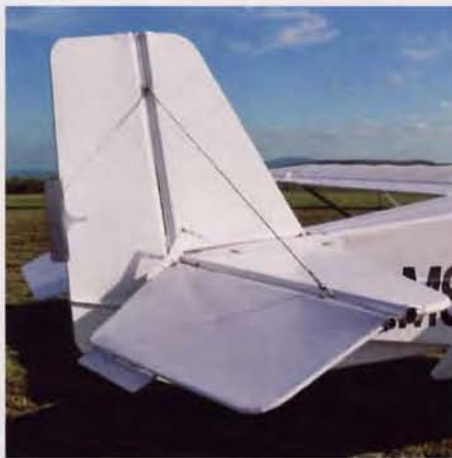
»Ebene Platte«: Das Leitwerksprofil lässt keine gewaltigen Ausschläge zu – daher die großen Ruder. Getrimmt wird mechanisch
