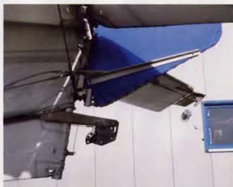
In der Erprobung: Schleppkupplung am SkyRanger. Das Seitenruder ist unten kürzer, durch mehr Tiefe aber gleich groß
