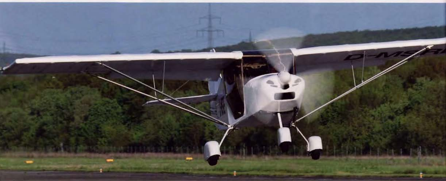
In der Erprobung: Schleppkupplung am SkyRanger. Das Seitenruder ist unten kürzer, durch mehr Tiefe aber gleich groß
