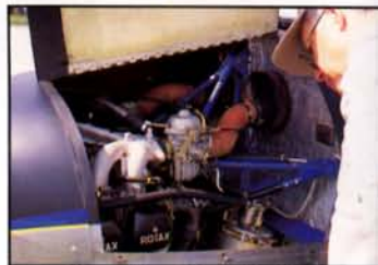
Viertakter: Der frühere Zweitakter Rotax ist einem 912 gewichen
