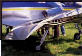
Fowlerklappe: in Deutschland nur mit einer Stellung (zehn Grad)
